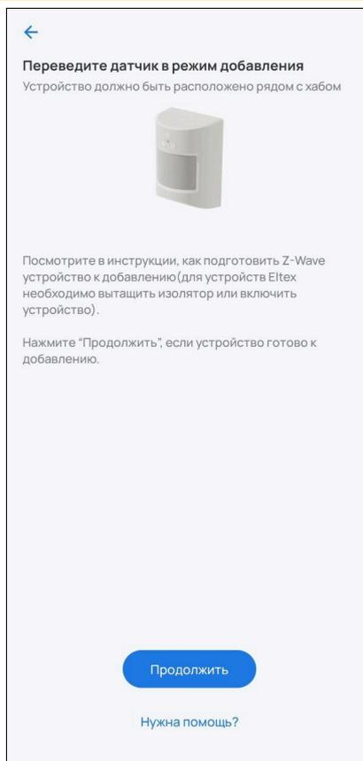
4. Нажмите сервисную кнопку на добавляемом устройстве 3 раза.
